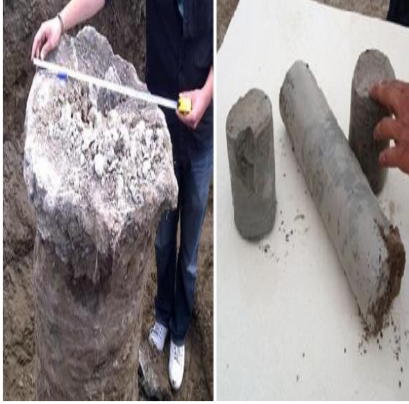
Şekil 12. DSM uygulaması kontrolü-2
